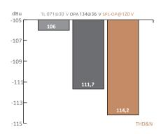
当涉及到音量时,120伏电压技术表现出的性能是普通元件和电路的两倍,在最大水平和动态范围方面,其数值大约高出10dB。SPL运算放大器的THD测量显示,与OPA134在36V时相比,差异超过3dB--就声压级而言,这相当于改进50%以上。
