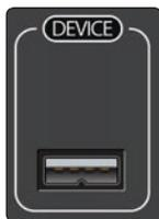
**设备接口。**这个接口可满足使用苹果设备兼容的 30 针脚连接线或者 Lightning 转 USB 的连接线来连接 AudioBox 到和 iPad，从而使用 iPad 里的音频软件进行录音或者重放。（我们建议用户使用 iPad 自带线缆，以防在使用非苹果的线材出现其他问题。）请查阅 iOS 设备系统最低要求。
