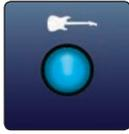
**输入源按键 (AudioBox iTwo)**。每一个 AudioBox iTwo 都提供一个乐器输入或线路输入的输入源按键。当按键没点亮时，此时为线路输入，用于连接如合成器或吉他放大音箱。当连接吉他或无源贝斯时，按下去这个按键就可以让乐器的前置放大器发挥作用了。
