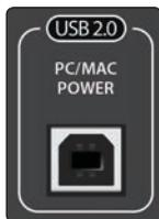
**USB 2.0/电源接口。**这个接口就是用来连接电脑和音频接口的，产品包装盒里的 USB 线就可以完成这个连接功能。并且由于 AudioBox iOne 和 iTwo 是通过这个连接实现总线供电，所以它们不需要外置的供电系统。当使用 iPad 的时候，这个接口也可以给音频接口供电。只需要很简单的使用已有的 USB 线连接到可兼容的 5V, 2.1A (2,100 mA) 电源上即可，iPad 上自带的接口即可满足。
