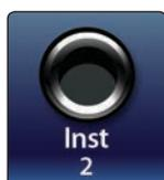
**乐器输入。** 这些 1/4" TS 接口适用于连接没有内置放大器的乐器（吉他、贝贝斯等）。请参照输入源按钮获取更多的信息。
