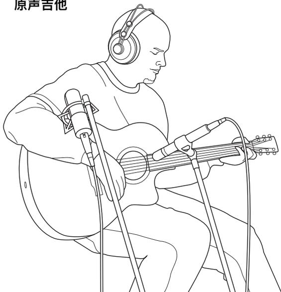
可以在离吉他12品大约8英寸的位置放置一个小振膜电容话筒。也可以在距离琴桥大约12英寸的地方摆放一个大振膜电容话筒。可以尝试不同的距离和话筒位置。另外一个流行的做法就是使用一两个小振膜电容话筒组成XY拾音制式。（可以参照下一页鼓组 overheads 的拾音方法。）
