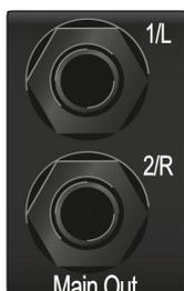
**Main Out。**这些是 Studio 系列接口的主输出。前面板的 Main 旋钮可以用来控制主输出的电平大小。重放流 1 和 2 被路由到这些输出。
