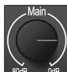
**Main 旋钮。** 可以控制 Studio 系列接口后面板主输出左右通道的输出大小，旋钮的范围可以从 -80 dB 到 0 dB。这个控制只提供衰减。
