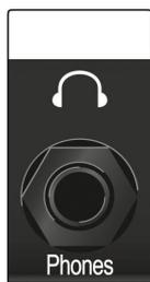
**耳机输出。**后面板的耳机输出可以在重放流 1/2 和 3/4 之间切换，和输出流主左 / 右输出以及输出 3/4 是一样的。这些重放流可以通过 **Cue A/B** 按键来进行切换。
