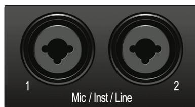
**Mic 输入。** Studio 系列接口配有高质量适用于所有类型麦克风的前置放大器。Studio 26c 特色的 XMAX-L 晶体管麦克风前置放大器对总线供电有着优化设计。Studio 68c 中特色的 XMAX 在双层增益级后又提供了一个一级的输入缓冲。
