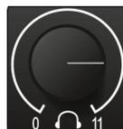
**耳机电平。** 这个旋钮可以控制后面板耳机输出的电平大小。
