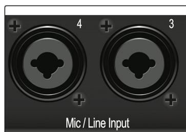
**麦克风/线路输入 (Studio 68c)。**这些麦克风 / 线路的组合接口可以用于麦克风的 XLR 输入以及 1/4'' TRS 接口的线路输入。
