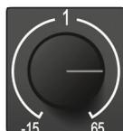
**MIC/LINE 输入增益控制。** 这些按键可以给麦克风和乐器输入提供 80 dB 的增益变化 (-15 到 +65 dB)，给线路输入提供了 40 dB 的增益变化 (-20 到 +20 dB)。
