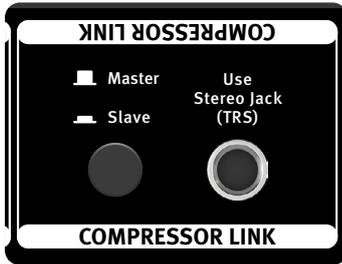
Mit der Compressor-Link-Funktion können die Kompressoren zweier Track One für den Stereobetrieb verbunden werden. Die zentrale Steuerung von einem Gerät aus sichert eine kohärente Stereobearbeitung.
