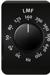
Mit dem LMF-Regler wird die Mittenfrequenz des halbparametrischen Bass-/Mittenfilters festgelegt (LMF: Low/Mid Frequencies = tiefe und mittlere Frequenzen). Der einstellbare Frequenzbereich liegt zwischen 30 Hz und 700 Hz, so dass dieses Filter vom untersten Bassbereich bis zum unteren Mittenbereich einen Umfang von etwa 4,5 Oktaven abdeckt. Zusammen mit dem LMF-Filter wird so das gesamte Frequenzspektrum abgedeckt.
