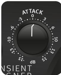
Mit dem Regler Attack kann die Einschwingphase eines Signals um bis zu 15 dB verstärkt oder abgesenkt werden. Positives Attack erhöht die Amplitude des Einschwingvorgangs. Negatives Attack führt zu einer Abschwächung der Amplitude des Einschwingvorgangs.
