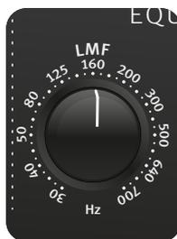
Mit dem LMF-Regler wird die Mittenfrequenz des halbparametrischen Bass-/Mittenfilters festgelegt (LMF: Low/Mid Frequencies = tiefe und mittlere Frequenzen). Der einstellbare Frequenzbereich liegt zwischen 30 Hz und 700 Hz, so dass dieses Filter vom untersten Bassbereich bis zum unteren Mittenbereich einen Umfang von etwa 4,5 Oktaven abdeckt. Zusammen mit dem LMF-Filter wird so das gesamte Frequenzspektrum abgedeckt.
