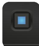
Tube Post 开关可改变信号流中电子管饱和的顺序：按下开关时，电子管饱和级位于均衡器级之后，输出级之前。未按下开关时，电子管饱和级直接位于前置放大器之后，去磁声器之前。
