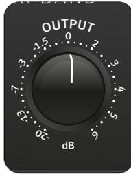
Mit dem Output-Regler kann der Ausgangspegel um bis zu -20 dB gedämpft oder um maximal +6 dB verstärkt werden. So wird sichergestellt, dass nachfolgende Geräte oder AD-Wandler optimal angesteuert werden.
