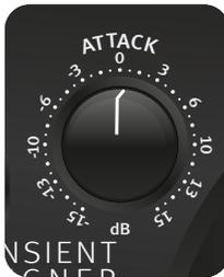
攻击可用于增加或衰减信号的瞬态相位，最高可达 15 dB。正攻击值会增加瞬态响应的幅度。负的攻击值则会导致衰减。
