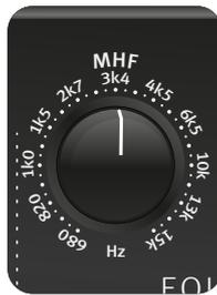
Mit dem MHF-Regler wird die Mittenfrequenz des halbparametrischen Mitten-/Hochtonfilters eingestellt (MHF: Mid/High Frequencies = mittlere und hohe Frequenzen). Der einstellbare Frequenzbereich liegt zwischen 680 Hz und 15 kHz, so dass dieses Filter einen Umfang von 4,5 Oktaven abdeckt und sowohl im unteren Mittenbereich als auch im Hochtonbereich eingesetzt werden kann.
