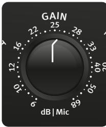
增益控制可用于调整前置放大。对于麦克风信号，可实现高达 68 dB 的前置放大。如果选择配备输入变压器，则必须在标定值的基础上增加约 +14 dB。
