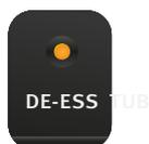
一旦检测到 S 声，DE-ESS LED 就会亮起。该指示灯只有在除磁声器开启时才会亮起，但其工作与设定的减弱值无关。换言之，它始终指示电路正在检测到磁声，因此您可以随时注意是否需要进行调整。
