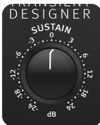
延音可以用来增加或衰减信号的延音相位，可达 24 dB。正的延音值可延长延音。负的持续值则会缩短持续时间。
