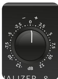
Der -/+ -Regler (rechts neben dem LMF-Regler) bestimmt die Verstärkung bzw. Absenkung des LMF-Filters.
