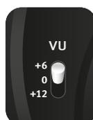
Zur besseren und intuitiveren Visualisierung der Signalpegel den VU-Schalter links unter dem VU-Meter kann der Anzeigebereich des VU-Meters an verschiedene Signalpegel angepasst werden.
