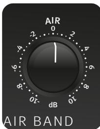
Das mit AIR bezeichnete Filter im EQ-Modul dient zur Bearbeitung des obersten Frequenzbereichs. Hier kommt ein Spulen-Kondensator-Filter mit einer Glockencharakteristik zum Einsatz, dessen Center-Frequenz bei 19 kHz liegt. Bei dieser Frequenz liegt die maximal mögliche Anhebung bei +10 dB, die maximal mögliche Dämpfung beträgt -10 dB.
