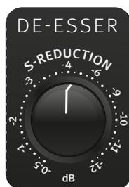
S-Reduction 控制器用于调节 S 音降低的强度。实际上，S-Reduction 设置在 -2 dB 和 -8 dB 之间时，大多数应用都能达到理想效果。
