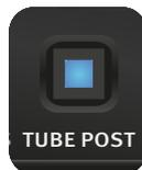
Mit der Taste Tube Post wird die Reihenfolge der Tube Saturation im Signalfluss verändert: Bei gedrückter Taste liegt die Tube-Saturation-Stufe hinter der EQ-Stufe und vor der Ausgangsstufe, bei nicht gedrückter Taste liegt die Tube-Saturation-Stufe direkt hinter dem Preamp und vor dem De-Esser.
