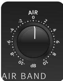
均衡器模块中的高频滤波器称为空气滤波器。线圈电容滤波器具有所谓的钟形特性，中心频率为 19 kHz。在此频率下，最大可能的重音为 +10 dB，最大可能的阻尼为 -10 dB。
