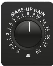
Mit dem Make-Up-Gain-Regler kann die durch Kompression hervorgerufene Gesamtpegelreduktion wieder aufgeholt werden. Es kann ein Wert zwischen 0 dB und 20 dB eingestellt werden, um den der Pegel nach dem komprimieren wieder angehoben wird.
