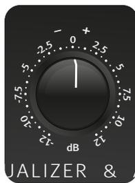
Der -/+Regler (rechts neben dem MHF-Regler) bestimmt die Verstärkung bzw. Absenkung des MHF-Filters.
