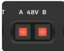
48V 开关可激活使用高密度麦克风所需的 48 伏幻象电源。两个麦克风输入均可单独激活幻象电源！
