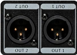
这些平衡输出连接器提供输出信号。Channel One Mk3 各提供两个并行输出。
