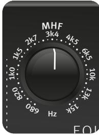
半参数中/高频滤波器的中心频率由 MHF 控制器设定。(MHF：中/高频)。频率范围可设置在 680 Hz 至 15 kHz 之间，因此该频率特性覆盖了 4.5 个八度音程，同样可用于中低频和低频范围。
