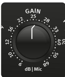
Über den Gain-Regler kann die Vorverstärkung eingestellt werden. Für Mikrofonsignale kann eine Vorverstärkung von bis zu 68 dB realisiert werden. Bei Ausstattung mit Eingangsübertrager müssen den skalierten Werten nochmals ca. +14 dB hinzugerechnet werden.
