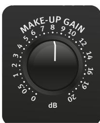
补偿增益控制用于弥补压缩造成的整体电平降低。可以设置一个介于 0 dB 和 20 dB 之间的值，使压缩后的电平再次提高。
