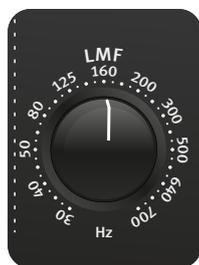
可调节的频率范围介于 30 Hz 和 700 Hz 之间，因此该滤波器的覆盖范围约为 4.5 个八度音阶，可用于从较深的低音到较低的中音。
