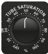
Mit dem Regler Tube Saturation wird der Grad der Röhrensättigung bestimmt. Der Ausgangspegel wird dabei weitgehend angepasst, im Maximalfall steigt der Pegel nur um ca. 6 dB. Es können dezente bis ausdrückliche harmonische Verzerrungen über einen weiten Effektbereich erzeugt werden.
