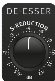
Mit dem Regler S-Reduction wird die Intensität der S-Laut-Reduzierung eingestellt. In der Praxis erzielen S-Reduction-Einstellungen zwischen -2 dB und -8 dB bei den meisten Anwendungen die besten Ergebnisse.
