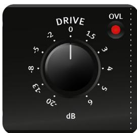
驱动控制进入滤波器网络的电平。电平的控制范围在 -20 dB 和 +6 dB 之间。在中心位置 (0dB)，驱动电平与输入电平相同。
