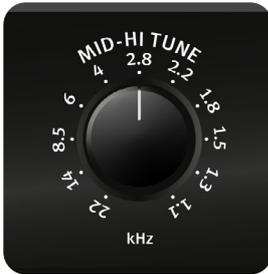
Mit dem Regler Mid-Hi Tune wird die Einsatzfrequenz oder untere Grenzfrequenz eingestellt, oberhalb welcher Frequenzen mit dem gewählten Process-Wert angehoben bzw. unterhalb welcher Frequenzen entsprechend gedämpft werden. Der Regelbereich des Reglers Mid-Hi Tune liegt zwischen 1,1 kHz im rechten Anschlag und 22 kHz im linken Anschlag.
