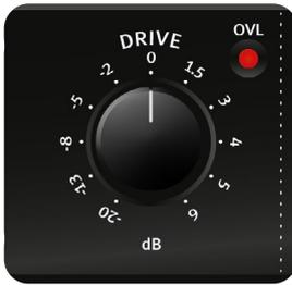
Der Regler Drive regelt die Ansteuerung des Filternetzwerks. Der Regelbereich liegt zwischen -20 dB und +6 dB. In der Center-Position (0dB) ist der Ansteuerungspegel identisch mit dem Eingangspegel.
