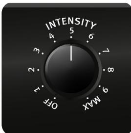
强度控制器决定 LC-EQ 的电平。随着强度的增加，高频和中频的增益也会增加。同时，感知时间也会发生变化，这样高频成分就不会被低频成分所掩盖。这就提高了语音的可懂度和清晰度。任何音频信号的亮度都能在不尖锐的情况下得到提高。
