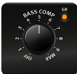
Stereo Vitalizer Mk3-T 具有简单易用、效果显著的 "单旋钮" 压缩器，它只集成到低音处理路径中，而不触及原始低音内容。压缩器的攻击、释放和阈值均已预先编程。增加低音压缩器的数值，一方面可以增加压缩比 (Ratio)，同时还能降低阈值 (Threshold)。该压缩器采用了柔和的膝部控制特性，听起来尽可能不突兀。由于它与低音通路融为一体，因此即使在强压缩率下，高音也能保持活泼、大气！
