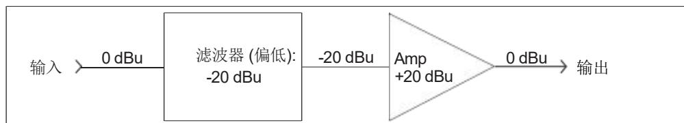
在+18dB升压下的无源滤波器方框图
