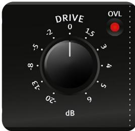
Der Regler Drive regelt die Ansteuerung des Filternetzwerks. Der Regelbereich liegt zwischen -20 dB und +6 dB. In der Center-Position (0dB) ist der Ansteuerungspegel identisch mit dem Eingangspegel.
