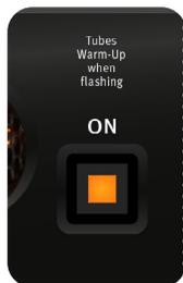
Über den On-Schalter wird der Vitalizer Mk3-T aktiviert. Im aktiven Zustand leuchtet der Schalter. Befindet sich das Gerät im Bypass-Modus, leuchtet der Schalter nicht.
